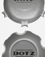
Plastique, peint en gris, fermé, uniquement 6 points de fixation Entraxe 139,7mm Hauteur 30,0mm N° d'article ZOD1
